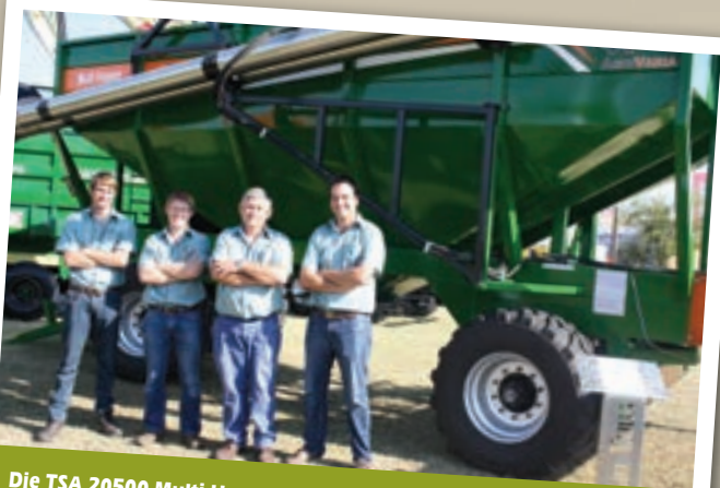
Die TSA 20500 Multi Hopper van Agri Varia het 'n laaikapasiteit van 25 ton en kan 500 kg per minuut ontlai. By hom staan die Agri Varia-span: Tiaan Richter (produksiebestuurder), Johandré Prins (bestuurder, Kaapstad), Paul Prins (direkteur) en Ulrich Neuen-schwander (hooftegnikus).
